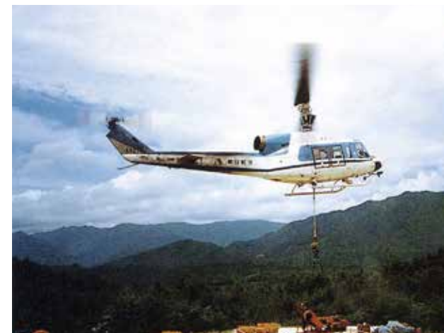
ヘリコプターによるボーリング機搬入
