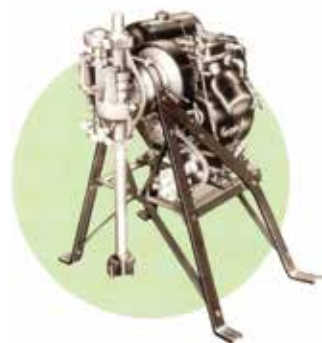
昭和27年にカナダから輸入したX-RAY型ボーリング機
