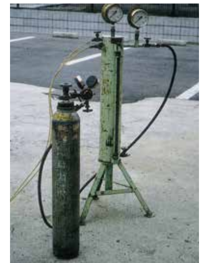
孔内水平載荷試験測定装置（LLT）
